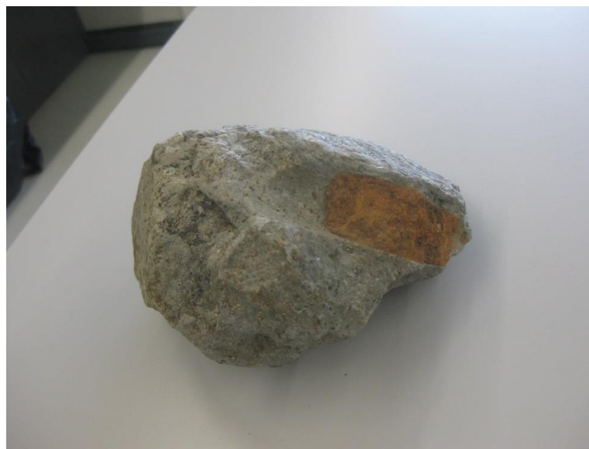
Figura 4- Orifício cilíndrico contendo terracota (mistura de óxido de ferro, cinza e resinas) em peça recolhida no lugar do Posto Santo.
